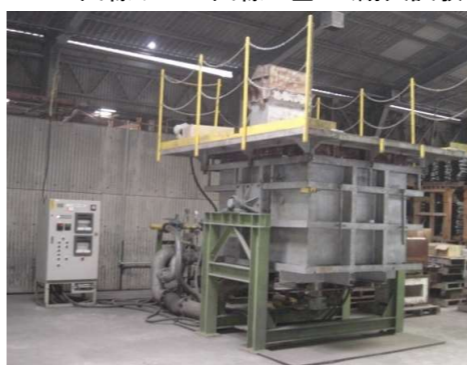
マルチ試験炉を用いた合成セグメントに対する耐火試験(2016.10実施分)
